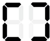
A nyitott ablakok érzékelése funkció aktiválásához tartsa lenyomva az időzítő gombot a kezelőpanelen 5 másodpercig. A hangjelző kétszer megszólal a funkció bekapcsolásának jelzésére, és egyszer megszólal a hangjelző a funkció kikapcsolásának jelzésére.
