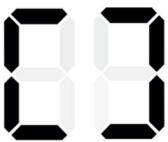
Pour activer la fonction de détection des fenêtres ouvertes, maintenez le bouton de la minuterie sur le panneau de commande pendant 5 secondes. L'avertisseur sonore retentit deux fois pour indiquer que la fonction est activée, et l'avertisseur sonore retentit une fois pour indiquer que la fonction est désactivée.
