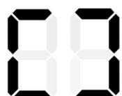
Щоб активувати функцію виявлення відкритих вікон, утримуйте кнопку таймера на панелі керування протягом 5 секунд. Два звукових сигналів означають, що функція увімкнена, один звуковий сигнал означає, що функція вимкнена.
