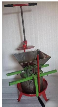
Bitte ziehen Sie die Druckplatte nicht zu fest an und überjustieren Sie sie nicht den Griff, um den Druck zu erhöhen, da dies die Presse beschädigen kann.
