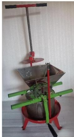
Dra inte åt tryckplattan för hårt och överjustera inte handtaget för att öka trycket, eftersom detta kan skada pressen.
