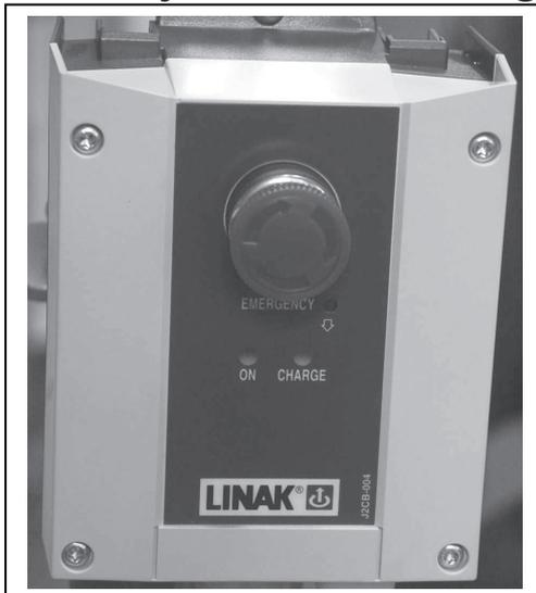
La caja de control está diseñada con una parada de emergencia roja y un cargador de batería interno.
