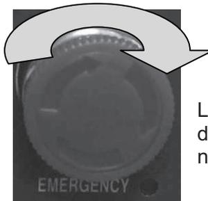
L'arresto di emergenza viene disattivato ruotando il pulsante rosso nella direzione delle frecce.
