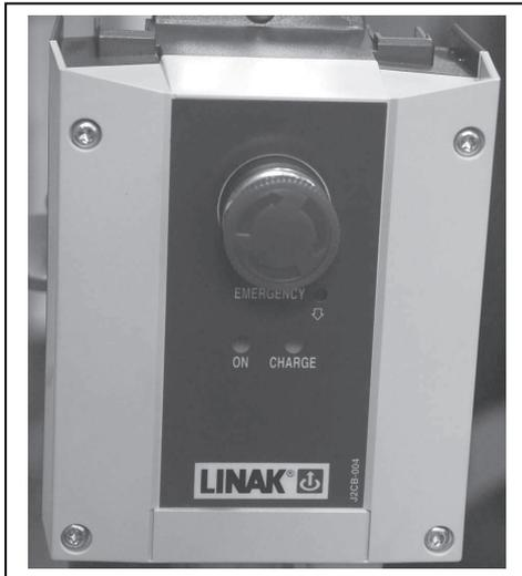
Die Kontrollbox ist mit einem roten Notstopp-Knopf und einem internen Batterieladegerät ausgestattet.
