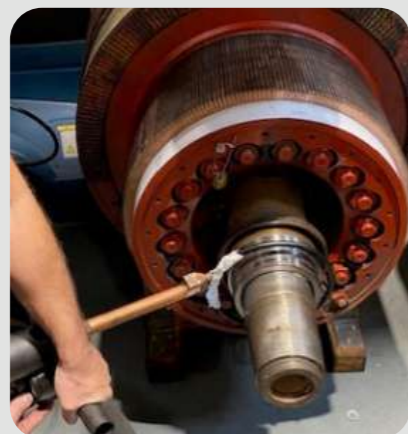
Usuwanie pierścieni z silnika elektrycznego : - Cewka indukcyjna okrągła L20/D200 - Powerduction 220LG
