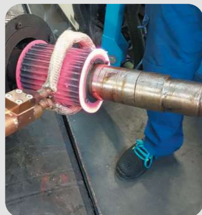
Podgrzewanie przekładni: - Cewka indukcyjna okrągła L180 - Powerduction 220LG
