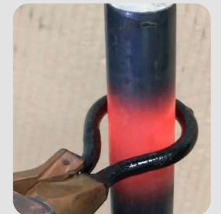
Podgrzewanie pręta : - Cewka indukcyjna okrągła S180/D25
