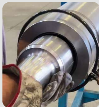
Fretowanie cylindrów do siłowników hydraulicznych. - Cewka indukcyjna okrągła L20/D200 - Powerduction 220LG
