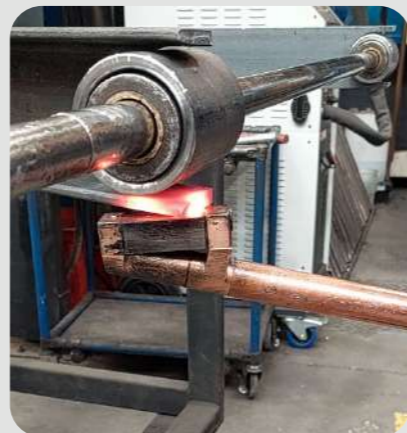
Produkcja konstrukcji przyczepy przed spawaniem: - Duża cewka indukcyjna L70 - Powerduction 220LG
