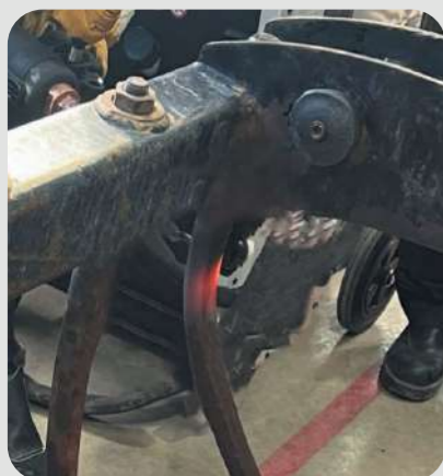
Prostowanie zębów łypek: - Duża cewka indukcyjna L20B4 - Powerduction 220LG
