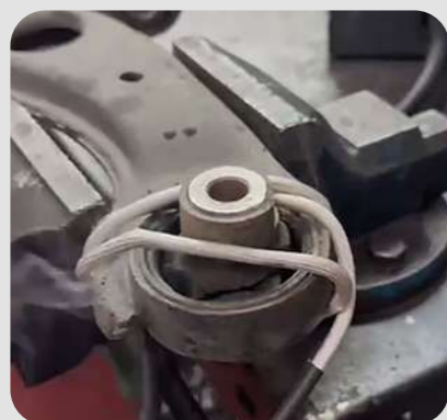
Zwalnianie przegubu kulowego wahacza: - Elastyczna cewka indukcyjna - Powerduction 10R
