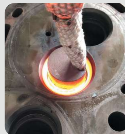
Nagrzewanie gniazda zaworu : - Cewka indukcyjna S180/D40 - Szerokość Ø 40
