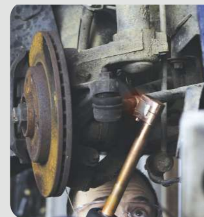
Odrzewianie drążków : - Mała cewka indukcyjna S90 - Powerduction 37LG
