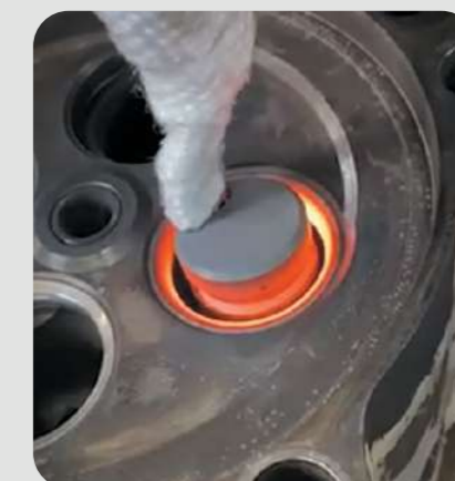
Nagrzewanie gniazda zaworu : - Induktor Heat Tube S180/D37 - Szerokość Ø 40
