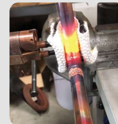
Lutowanie za pomocą pierścienia na złączce o średnicy Ø28 : - Cewka indukcyjna BRAZ L90
