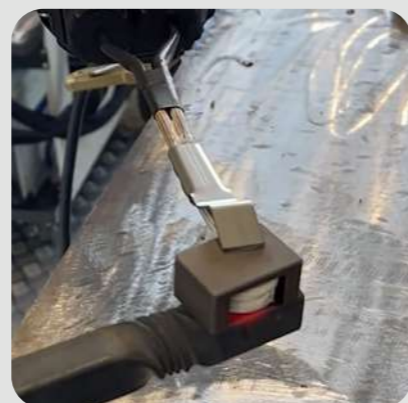
Ogrzewanie prętów stalowych: - Cewka indukcyjna 10R/B5 - Powerduction 10R
