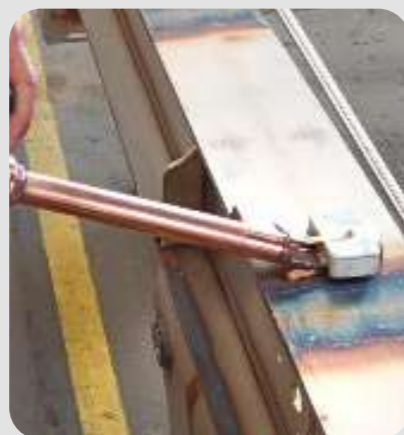
Prostowanie ram ze stali nierdzewnej: - Duża cewka indukcyjna L20B4
