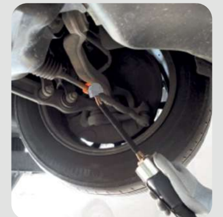
Odkręcanie drążków kierowniczych : - Mała cewka indukcyjna S20/B1
