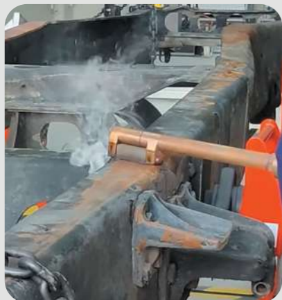
Prostowanie konstrukcji pojazdu ciężarowego: - Duża cewka indukcyjna L90 - Powerduction 220LG
