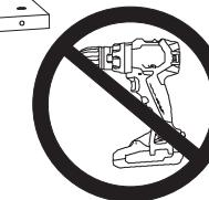
PRZESTRZEGAMY PRZED UŻYCIEM WKRĘTARKI DO PRZYKREĆENIA LISTEW, ZBYT DUŻA SIŁA UŻYTA DO PRZYKREĆENIA WKRĘTÓW SPOWODUJE PRZEKRĘCENIE SIĘ ŚRUBY CO W KONSEKWENCJI PROWADZI DO USZKODZENIA ELEMENTÓW ORAZ ODPADNIĘCIA LISTWY
