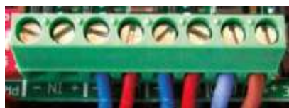
Dodatkowe wejście Zawór gazu Zapłon Zasilanie 12 V
