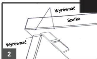
Jeśli drzwiczki nie są osadzone są w ramie [rys. 1] wyrównaj bok zatrzasku z bokiem ramy. Przód zatrzasku wyrównaj z ramą szafki [rys. 2].
