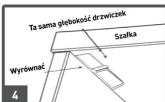
Jeśli drzwiczki są osadzone są w ramie [rys. 3] zatrzask powinien znajdować się na tej samej głębokości, co drzwiczki. [rys. 4].
