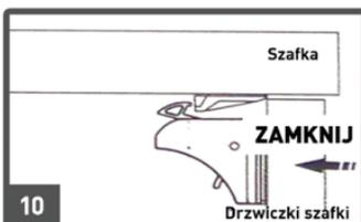
Przytóż kluczyk magnetyczny do powierzchni, wyrównaj z blokadą aby otworzyć [rys. 9]. Zamykanie [rys. 10].
