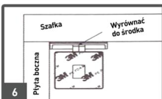
Przymocuj mechanizm blokady do wnętrza drzwiczek na tym samym poziomie co zatrzask [rys. 5] i wyrównując do środka zatrzasku [rys. 6].
