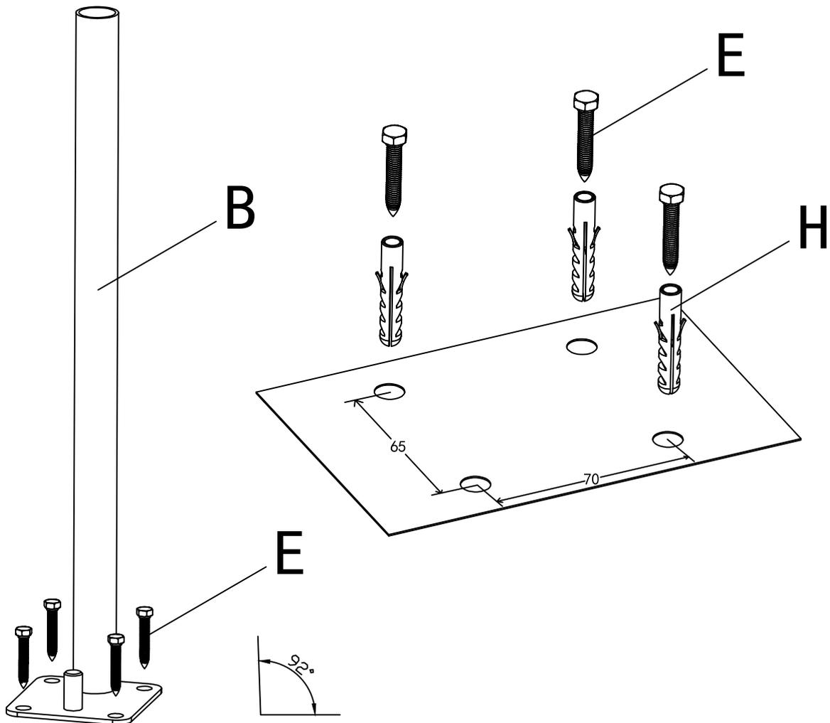
Słupek został celowo przyspawany pod kątem 92 stopni, aby umożliwić prawidłowy montaż i funkcjonalność markizy.
