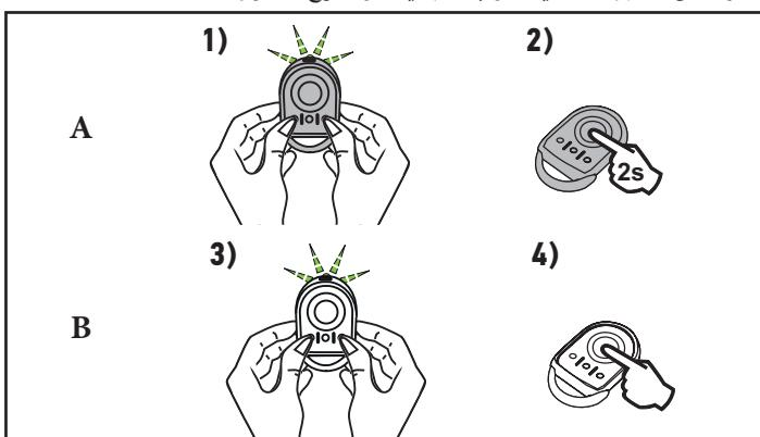
جهاز التشغيل عن بعد "A" = جهاز التشغيل عن بعد "المصدر" المُخزن بالذاكرة مسبقاً
