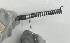
Insérez la clé et poussez l'arbre avec les deux mains sens opposé à la fente en T du terminal pour retirer le
