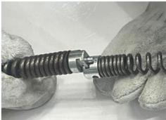
Poussez la perceuse le long de la fente coulissante à 67° de l'arbre pour l'engager. Cela rend la connexion plus fiable, facile et rapide.
