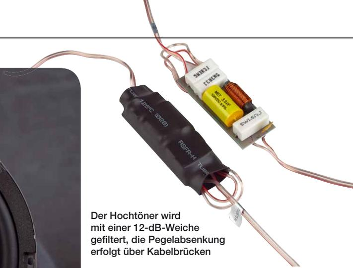
Der Hochtöner wird mit einer 12-dB-Weiche gefiltert, die Pegelabsenkung erfolgt über Kabelbrücken
