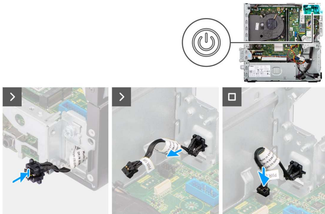
Rysunek 36. Instalowanie przycisku zasilania
