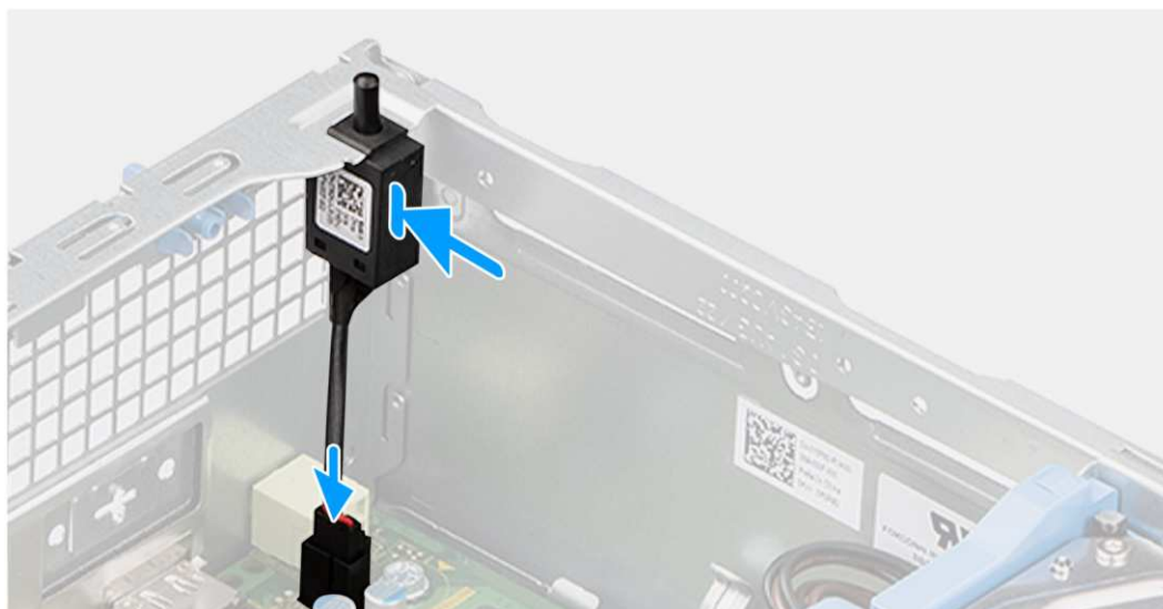
Rysunek 34. Instalowanie czujnika naruszenia obudowy
