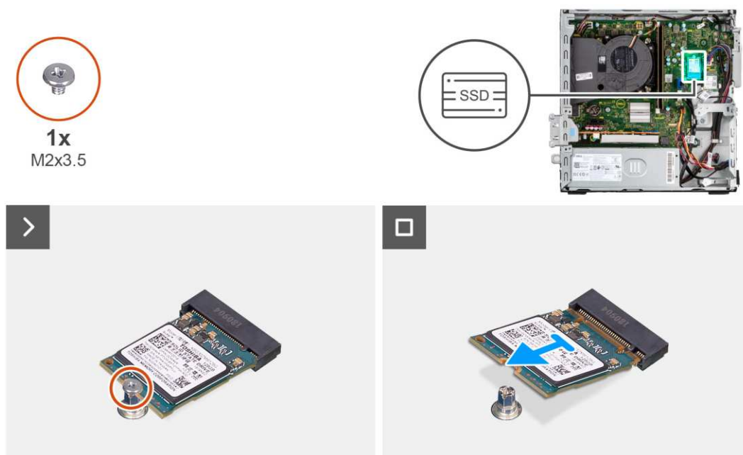
Rysunek 17. Wymontowywanie dysku SSD M.2 2230
