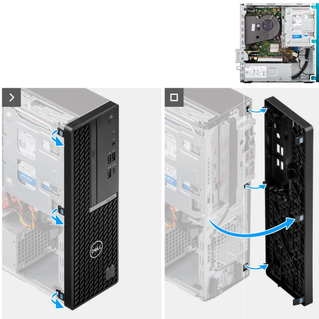
Rysunek 7. Wymontowywanie ramki przedniej
