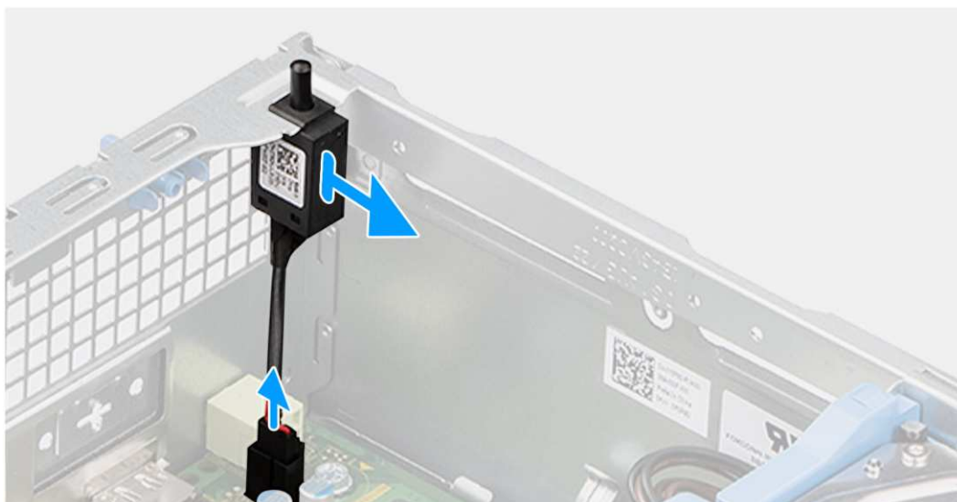
Rysunek 33. Wymontowywanie czujnika otwarcia obudowy
