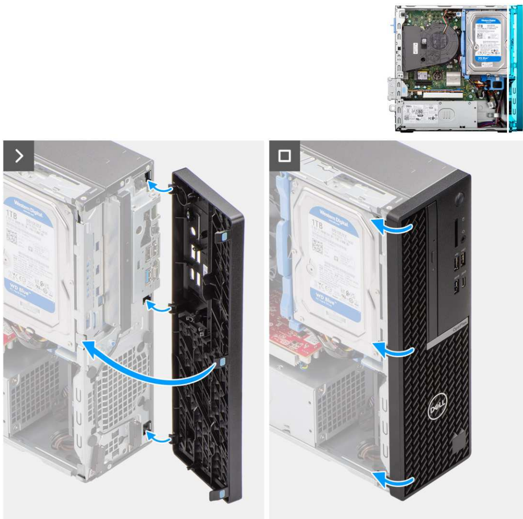
Rysunek 8. Instalowanie ramki przedniej
