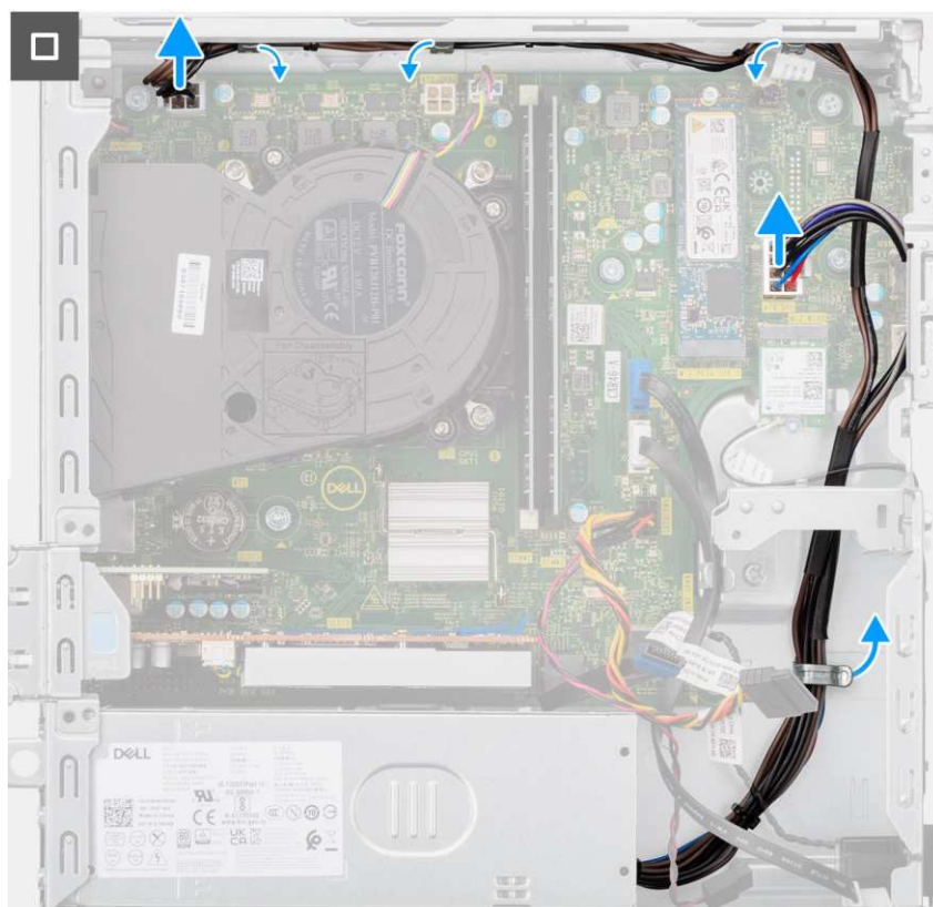
Rysunek 43. Instalowanie zasilacza
