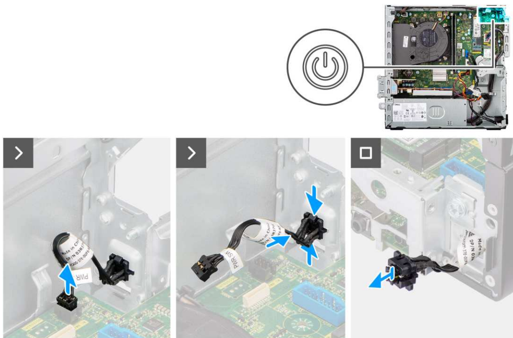
Rysunek 35. Wymontowywanie przycisku zasilania
