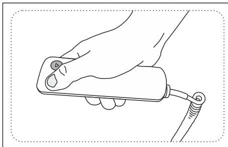
Die Steuerung erfolgt durch Drücken einer der mit Pfeilen gekennzeichneten Tasten - nach oben / nach unten.
