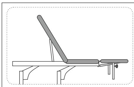
Regulacja segmentu tylnego leżyska odbywa się za pomocą mechanizmu typu Rastomat. Podnieść segment do wybranej pozycji, mechanizm zablokuje się samoczynnie.
