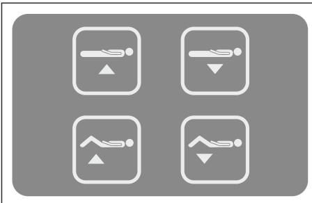
Bei ausgewählten Optionen besteht neben der Einstellung der Gesamthöhe der Tischplatte auch die Möglichkeit, den Neigungswinkel des Bettes im Bereich von 0-25° zu verstellen. Die Steuerung erfolgt durch Drücken einer der mit Pfeilen markierten Tasten - hoch / runter.
