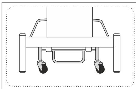
Das Antriebssystem wird durch Anheben des Tisches mit dem Fußhebel aktiviert. Durch Herunterdrücken des Hebels kann der auf Rollen gestützte Tisch bewegt werden. Um den Tisch in der gewählten Position zu blockieren, senken Sie den Tisch auf die Füße ab, indem Sie den Hebel in die obere Position heben.
