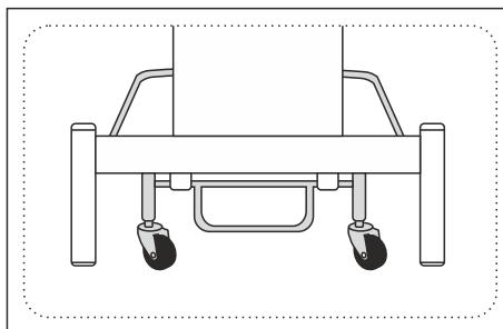
System jazdny uruchamia się poprzez podniesienie stołu za pomocą dźwigni nożnej. Po naciśnięciu dźwigni w dół, stół wsparty na kółkach można przemieszczać. W celu zablokowania stołu w wybranej pozycji należy opuścić stół na stopki poprzez podniesienie dźwigni do górnej pozycji.
