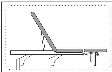
Die Verstellung des hinteren Teils des Sitzes erfolgt über einen Rastomat-Mechanismus. Heben Sie das Segment in die ausgewählte Position an, der Mechanismus verriegelt sich automatisch.
