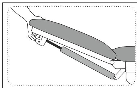
Po zwolnieniu dźwigni, należy ustawić podglówka w żądanym położeniu.
