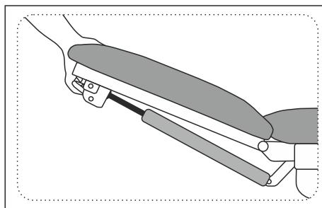
Nachdem der Hebel losgelassen wird, ist das Kopfkissen in die gewünschte Position zu bringen.
