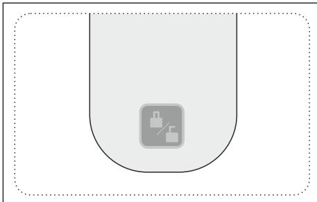
Stół wyposażony jest w wyłącznik bezpieczeństwa umieszczony na pilocie zdalnego sterowania. Po wciśnięciu i przytrzymaniu przez 3 sekundy funkcja podnoszenia i opuszczania stołu zostaje zablokowana. Celem odblokowania funkcji należy ponownie przytrzymać przycisk przez kolejne 3 sekundy.
