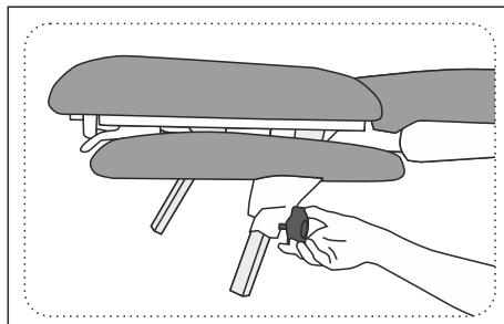
Um die Armlehne abzusenken, schrauben Sie den Knopf gegen den Uhrzeigersinn ab und stellen Sie dann die Höhe auf die gewünschte Position ein. Ziehen Sie dann den Knopf im Uhrzeigersinn fest.
