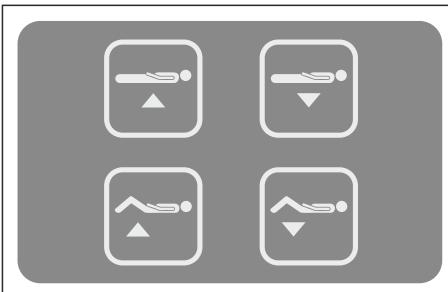
W wybranych opcjach oprócz regulacji całkowitej wysokości blatu istnieje możliwość regulacji kąta łamania leżyska w zakresie 0-25°. Sterowanie odbywa się poprzez naciśnięcie jednego z przycisków oznaczonych strzałkami góra / dół.
