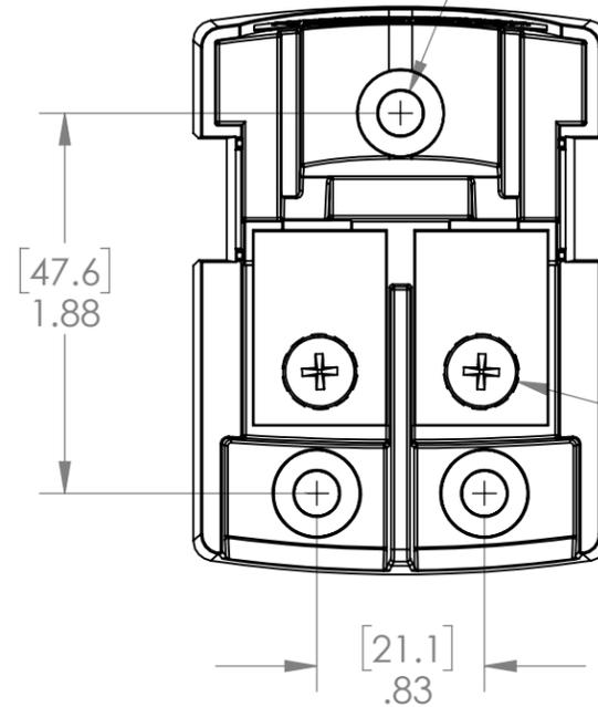
2X 10-32x1/2" ST. STEEL wETLW TERMINAL SCREWS FOR #10 OR M5 TERMINALS
