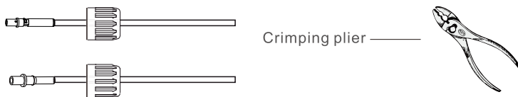
Rys. 3.4 Zacisnąć pin stykowy na przewodzie
