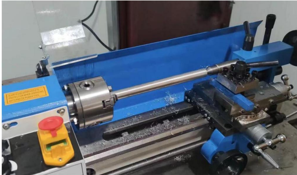
Figuur 6 Werkstuk vasthouden en boren
