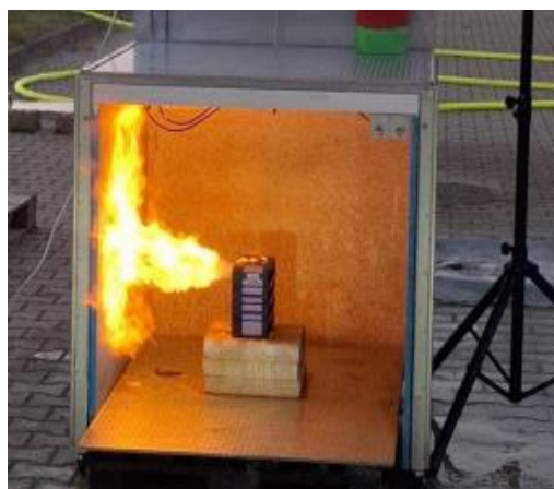
Zdjęcie nr 4. Charakterystyczny dla baterii litowo-jonowych, pożar strumieniowy typu jet
