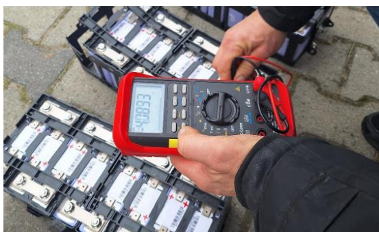
Zdjęcie nr 1. Sprawdzenie stanu naładowania ogniw przed rozpoczęciem badań
