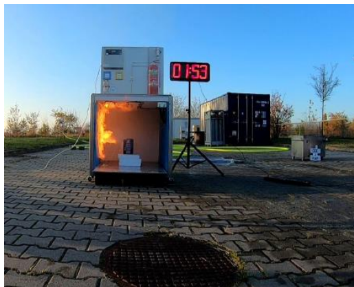
Zdjęcie nr 3. Przebieg testu pożarowego dedykowanego urządzenia gaśniczego
