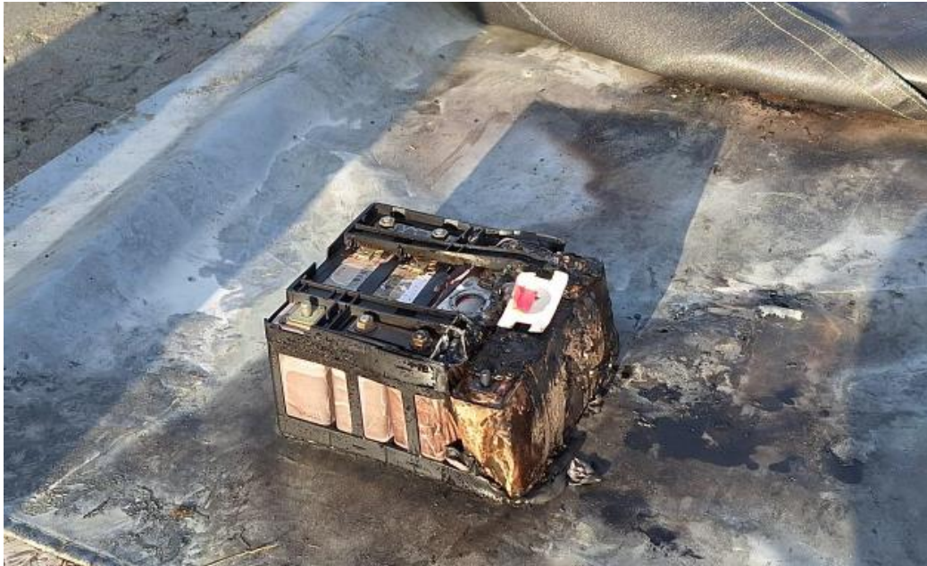
Zdjęcie nr 6 . Widok baterii wykorzystanej w próbie ogniowej. Widoczne uszkodzenia dwóch ogniw i nienaruszony stan dwóch kolejnych ogniw.
