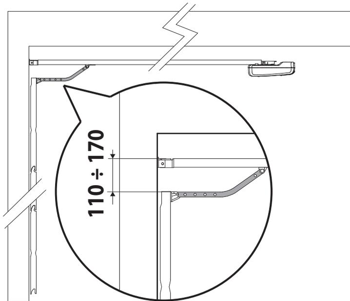
É aconselhável posicionar o operador de forma a manter o ramo dianteiro da alavanca o mais horizontal possível (ver figura), sem prejuízo de que será verificada, pelo instalador, a conformidade com a normativa relativa aos impactos.
