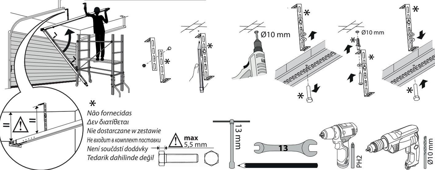
**F** MONTAGEM DO TRAÇO DE TRAÇÃO - ΣΥΝΑΡΜΟΛΟΓΗΣΗ ΒΡΑΧΙΟΝΑ ΕΛΚΥΣΗΣ-MONTAŻ RAMIENIA POCIĄGOWEGO
