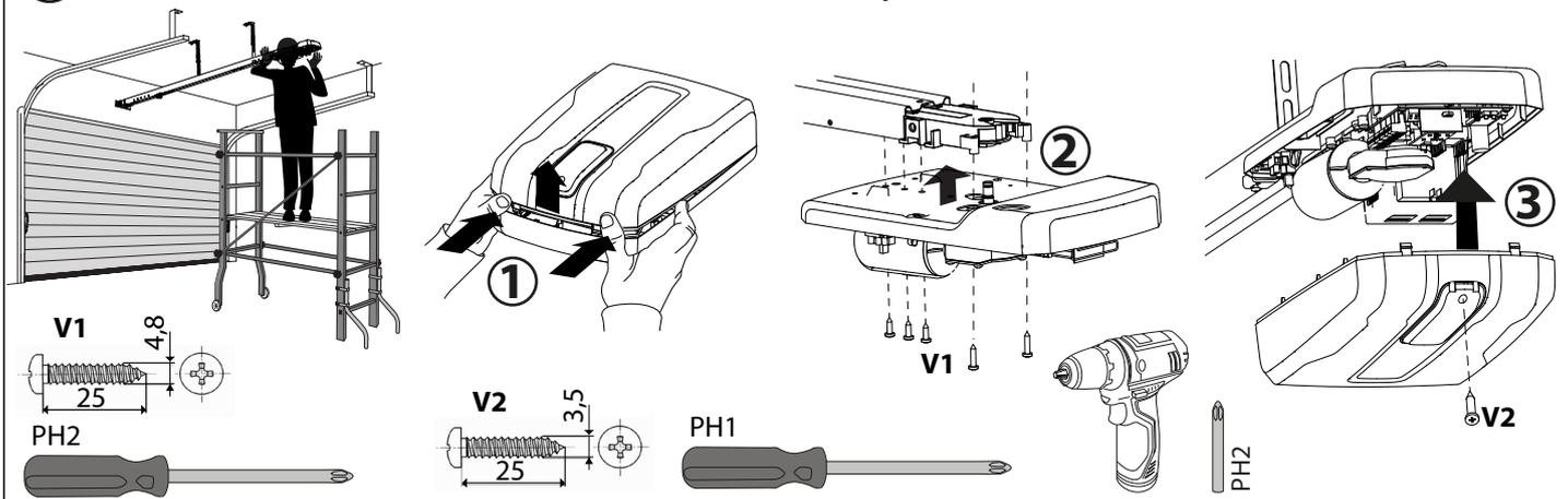
**H** INSTALAÇÕES ESPECIAIS COM CABEÇA GIRADA - ΕΓΚΑΤΑΣΤΑΣΗ ΛΕΠΤΟΜΕΡΕΙΩΝ ΜΕ ΤΗΝ ΚΕΦΑΛΗ ΓΥΡΙΣΜΕΝΗ
