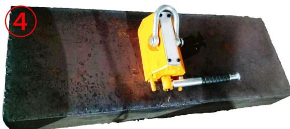
Dernière étape, après avoir confirmé que le poussoir magnétique permanent est fermé, retirez le poussoir magnétique permanent et stockez-le dans un endroit sec pour éviter la rouille.
