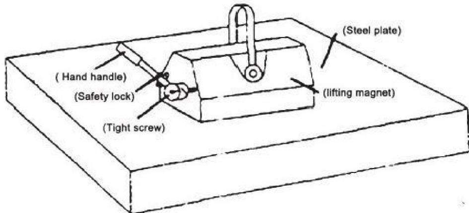
I det första steget, placera den permanenta magnetiska lyftaren i mitten av stålet.
