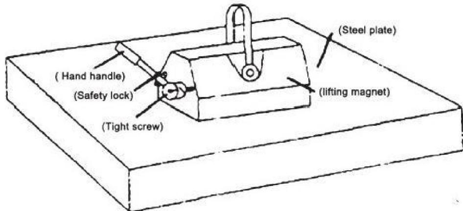
En el primer paso, coloque el elevador magnético permanente en el centro del acero.
