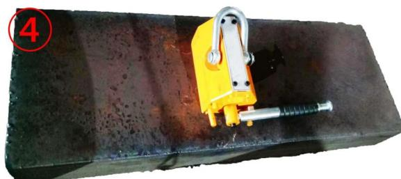
El último paso, después de confirmar que el elevador magnético permanente está cerrado, retire el elevador magnético permanente y guárdelo en un lugar seco para evitar la oxidación.
