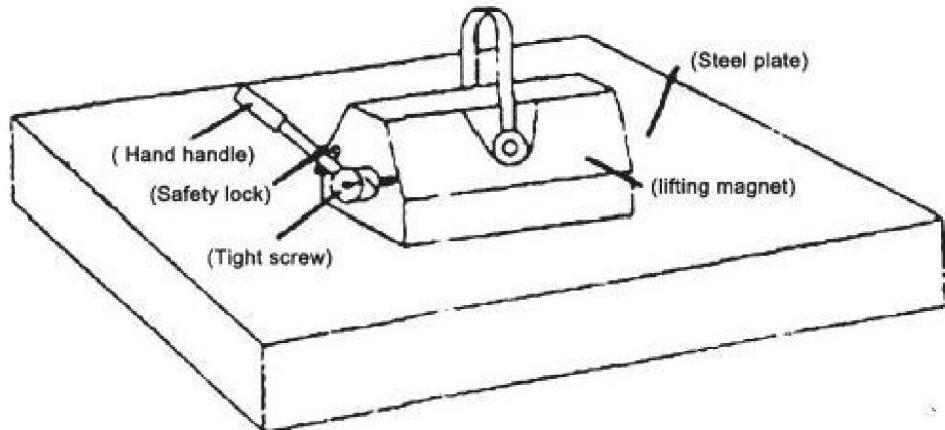
Platzieren Sie im ersten Schritt den Permanent-Magnetheber mittig auf dem Stahl.
