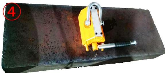
L'ultimo passaggio, dopo aver verificato che il sollevatore magnetico permanente sia chiuso, è rimuoverlo e riporlo in un luogo asciutto per evitare la ruggine.
