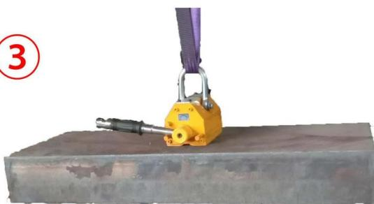
Appuyez sur le bouton de la poignée et maintenez-le enfoncé pour déplacer la poignée de la position ON à la position OFF.
