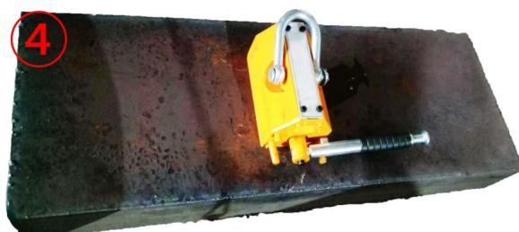
Ostatnim krokiem jest upewnienie się, że podnośnik magnetyczny jest zamknięty. Należy wyjąć podnośnik magnetyczny i schować go w suchym miejscu, aby zapobiec rdzewieniu.
