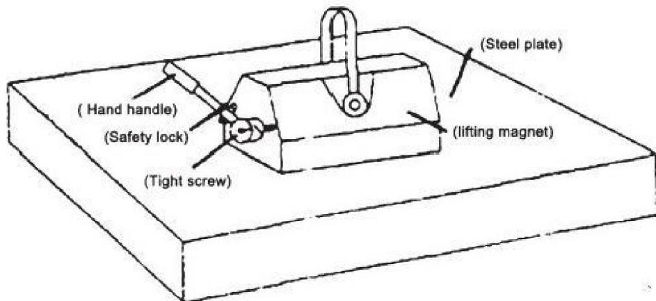
Nel primo passaggio, posizionare il sollevatore magnetico permanente al centro dell'acciaio.
