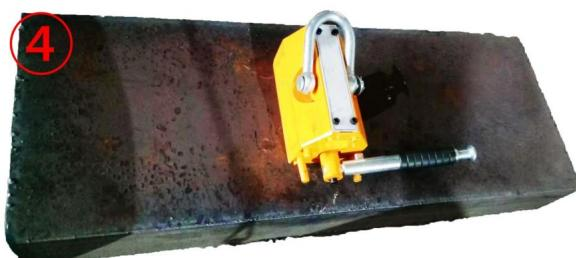
Det sista steget, efter att ha bekräftat att den permanentmagnetiska lyftaren är stängd, ta bort den permanentmagnetiska lyftaren och förvara den på en torr plats för att förhindra rust.
