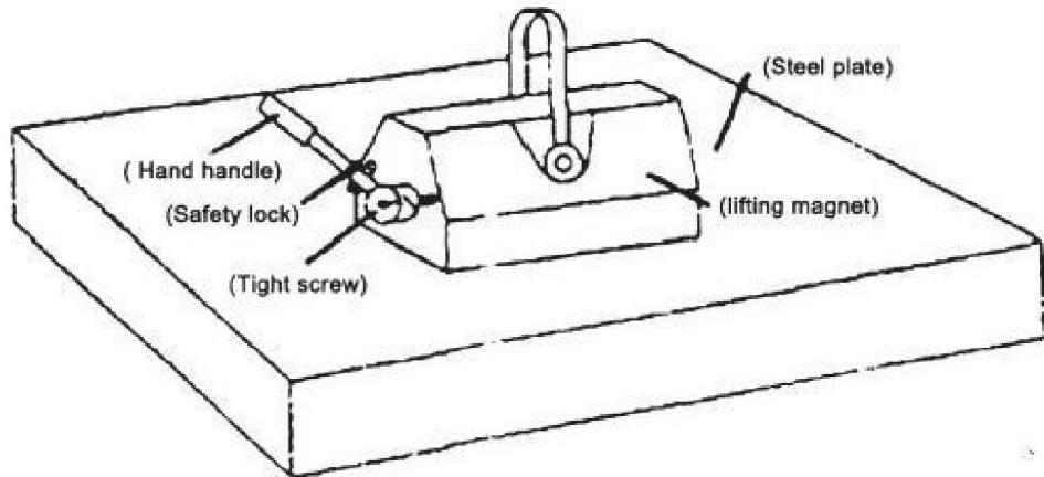
Plaats als eerste stap de permanente magneetlift in het midden van het staal.
