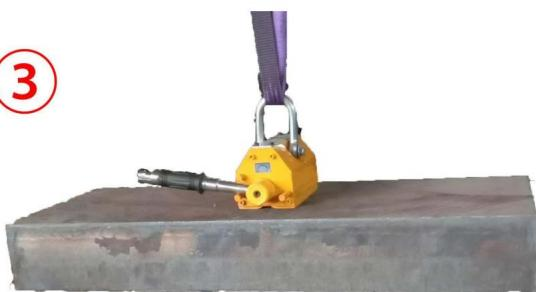
Mantenga presionado el botón del mango para mover el mango de la posición ON a la Posición OFF.
