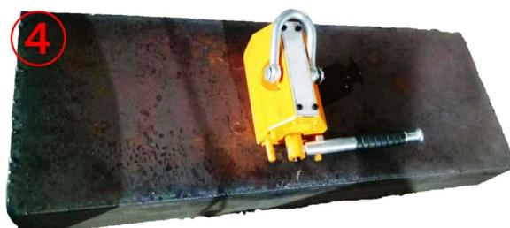
De laatste stap is om, nadat u hebt gecontroleerd of de permanente magneetheffer gesloten is, de permanente magneetheffer te verwijderen en op een droge plaats op te bergen om roest te voorkomen.
