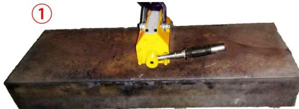
La deuxième étape consiste à appuyer sur le bouton de la poignée et à tourner la poignée de OFF à ON, et la poignée ne peut être libérée qu'une fois le verrou de sécurité verrouillé. Il est strictement interdit de l'utiliser à vide ou en surcharge.
