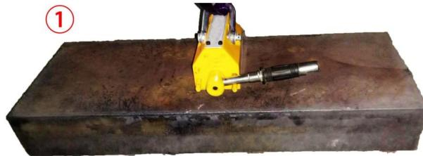
De tweede stap, druk op de hendelknop en draai de hendel van UIT naar AAN, en de hendel kan alleen worden losgelaten nadat de veiligheidsvergrendeling is vergrendeld. Het is strikt
