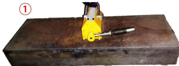
Il secondo passaggio, premere il pulsante della maniglia e girare la maniglia da OFF a ON, e la maniglia può essere rilasciata solo dopo che il blocco di sicurezza è bloccato. È rigorosamente vietato utilizzarlo senza carico o in sovraccarico.
