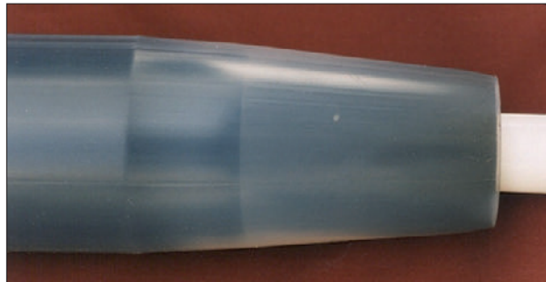
(Rys. 3 Zanik pęcherzyków powietrza w szczelinie między korpusem mufy CAM a elementem sterującym FSE)
