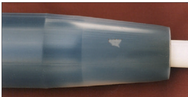
(Rys. 3 Zanik pęcherzyków powietrza w szczelinie między korpusem mufy CAM a elementem sterującym FSE)
