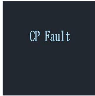
4.3 Falla de CP: el dispositivo detecta que el voltaje de CP excede  $6\text{ V} \pm 0,8$  o  $9\text{ V} \pm 0,8$ , informa una falla de CP, recupera el voltaje dentro del rango y recupera la falla.
