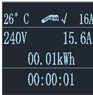
2. 3 Dopo aver inserito la testa della pistola di ricarica nella porta di ricarica del veicolo, l'interfaccia di ricarica è mostrata di seguito :
