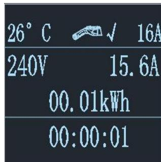
2. 3 Después de insertar el cabezal de la pistola de carga en el puerto de carga del vehículo, la interfaz de carga se muestra a continuación :
