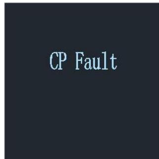
4.4 Falla por sobrecorriente: si la corriente de carga del dispositivo excede el umbral y continúa excediendo los 5 s, el dispositivo desconectará la carga y reportará una falla, que no se puede restaurar automáticamente.
