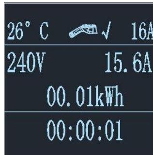
2.3 Po włożeniu głowicy pistoletu ładowającego do portu ładowania pojazdu, poniżej pokazany jest interfejs ładowania :
