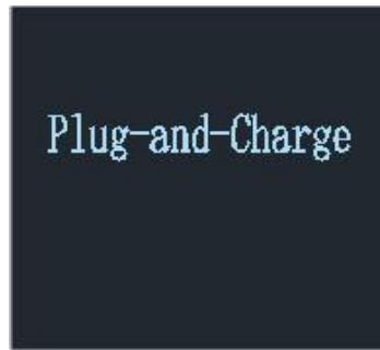
Drücken und halten Sie das Ladefeld erneut, und auf dem Bildschirm wird „Plug and Charge“ angezeigt, um in den Plug-and-Play-Lademodus zu wechseln . Öffnen Sie Standort, Bluetooth und WLAN des Mobiltelefons. Wenn sich das Ladegerät im Standby-Zustand befindet, sucht die App automatisch nach dem Ladegerät und der Gerätename wird angezeigt.
