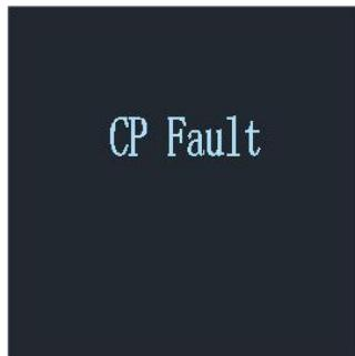
4.3 Défaut CP : L'appareil détecte que la tension CP dépasse  $6 \text{ V} \pm 0,8$  ou  $9 \text{ V} \pm 0,8$ , signale un défaut CP, récupère la tension dans la plage et récupère le défaut.
