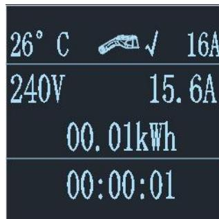
2. 3 Après avoir inséré la tête du pistolet de charge dans le port de charge du véhicule, l'interface de charge est illustrée ci-dessous :
