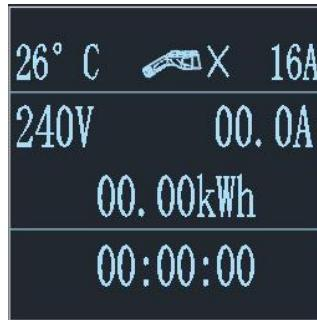
2. 1 Ajuste la corriente de carga: haga clic en el botón para ajustar el engranaje de carga: 16A-13A-10A-8A-16A. Cicle la corriente en este orden. Después de cambiar la corriente de uso, conecte el cabezal de la pistola para cargar.
