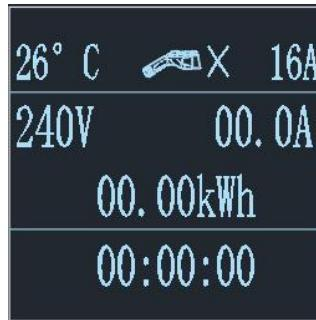
2. 1 Dostosuj prąd ładowania: kliknij przycisk,
