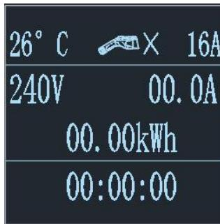
2. 1 Regola la corrente di carica: fai clic sul pulsante
