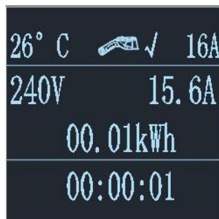
2. 3 Nachdem Sie den Kopf der Ladepistole in den Ladeanschluss des Fahrzeugs eingesteckt haben, wird die Ladeschnittstelle unten angezeigt :
