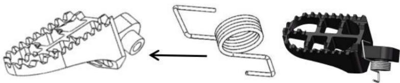
**Schritt 2** Setzen Sie das C auf den kurzen Schaft von B, das größere Der Haken sollte wie im Bild rechts an A aufgehängt werden.
