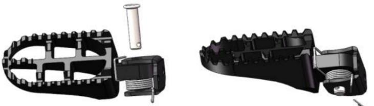
**Schritt 4** Setzen Sie die Schraube ein und stecken Sie den Befestigungsstift in die kleine Loch. Biegen Sie den Stift mit einer Spitzzange, um die Schraube zu fixieren.
