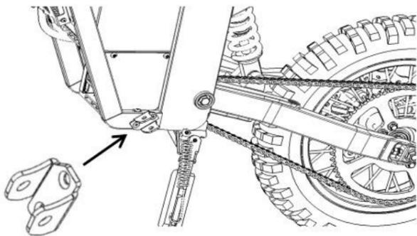
**Schritt 1** Befestigen Sie die Basisstütze A an der Karosserie.
