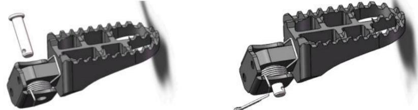
**Schritt 4:** Setzen Sie die Schraube ein und stecken Sie den Befestigungsstift in das kleine Loch. Biegen Sie den Stift mit einer Spitzzange, um die Schraube zu fixieren.
