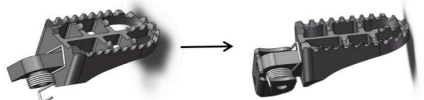
**Schritt 3** Hängen Sie zuerst den kleineren Haken an A und drücken Sie dann B und C mit etwas Kraft in das A, in die gleiche Richtung wie gezeigt.
