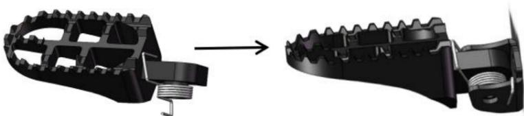
**Schritt 3** Hängen Sie zuerst den kleineren Haken an A und drücken Sie dann B und C mit etwas Kraft in das A, in die gleiche Richtung wie gezeigt.
