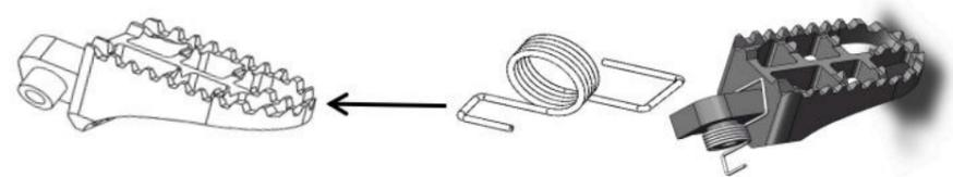
**Schritt 2** Setzen Sie das C auf den kurzen Schaft von B, das größere Der Haken sollte wie im Bild rechts an A aufgehängt werden.
