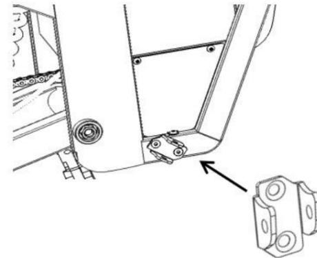
**Schritt 1** Befestigen Sie die Basisstütze A an der Karosserie.
