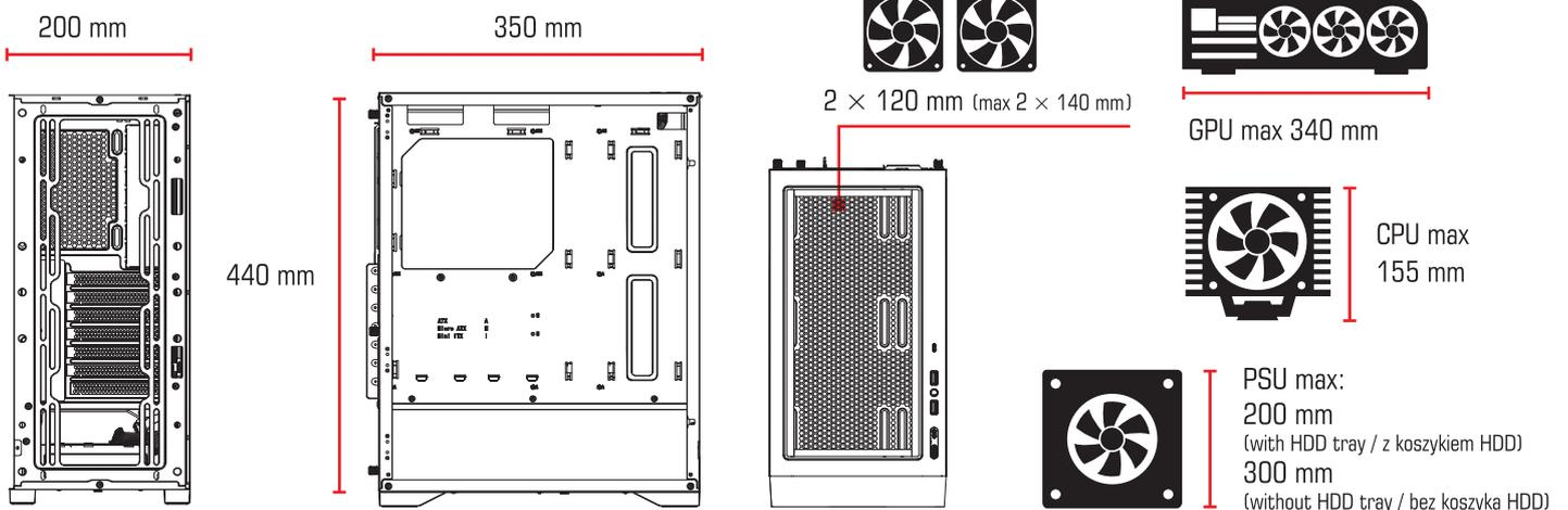
PC case dimensions / wymiary obudowy PC: 385 × 200 × 456 mm (L × W × H)
