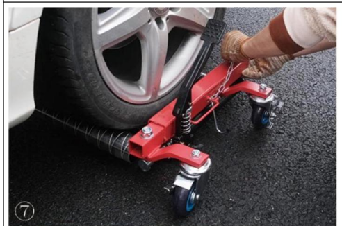
7. Upewnij się, że zawleczka została zablokowana na miejscu.
