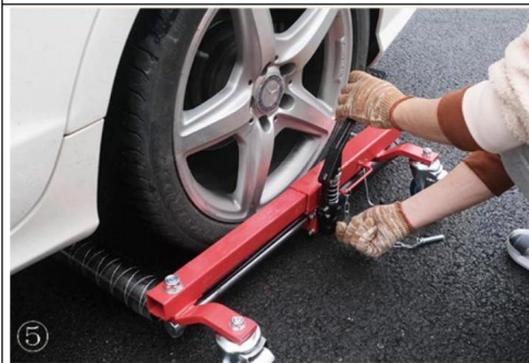
5. Fermez la valeur de déverrouillage en tournant le volant
