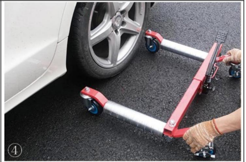
4. Faites glisser les chariots Go Wheel autour du roue à soulever.
