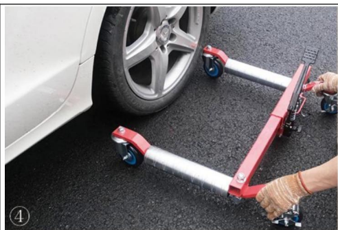
4. Przesuń wózki z kółkami go wokół koło do podniesienia.
