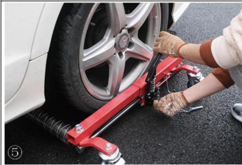
5. Stäng frigöringsvärdet genom att vrida på handratten medurs.
