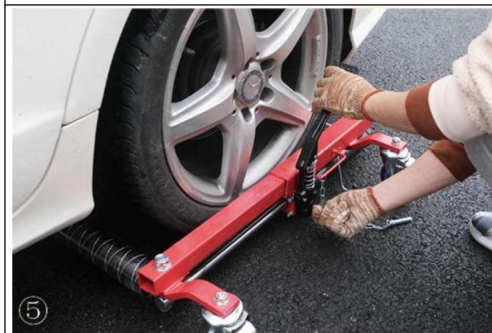
5. Zamknąć wartość zwolnienia, obracając pokrętkę
