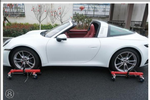
8. Pour libérer les chariots à roues, tirez sur la goupille hors du cadre et ouvrez la valeur en tournant volant dans le sens inverse des aiguilles d'une montre.
