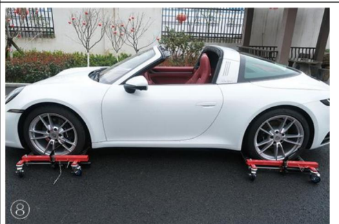
8. Aby zwolnić wózek z kółkami, pociągnij za sworzeń poza ramę i otwórz wartość, obracając pokrętkę w kierunku przeciwnym do ruchu wskazówek zegara.
