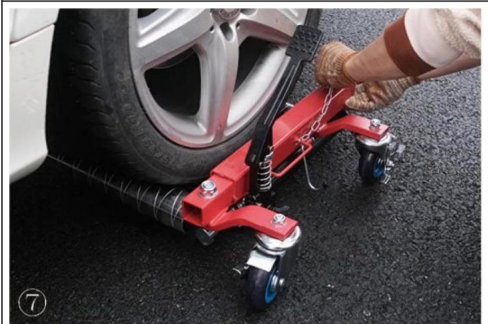
7. Se till att låsa stiftet på plats.
