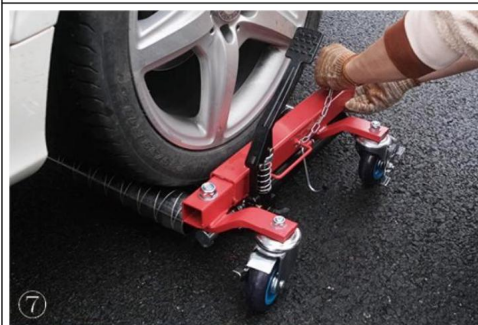
7. Assurez-vous de verrouiller la goupille en place.
