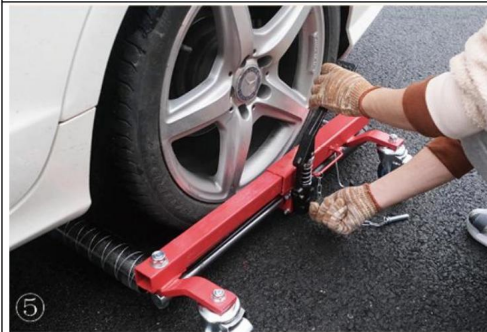
5. Auslöseventil durch Drehen des Handrades schließen im Uhrzeigersinn.
