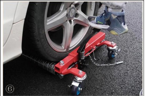
6. Sätt foten på pedalen och tryck ned den smidigt att lyfta däckets från ytan en tum eller mindre.
