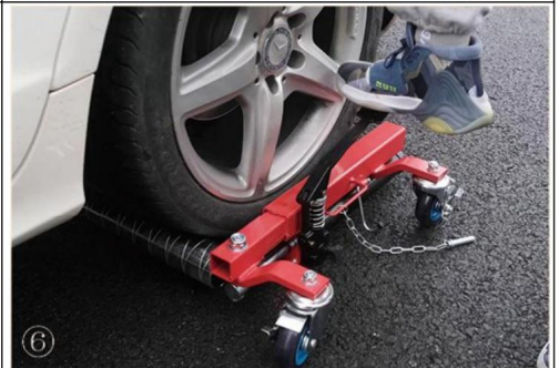
6. Stellen Sie den Fuß auf das Pedal und drücken Sie um den Reifen sanft einen Zoll von der Oberfläche anzuheben oder weniger.
