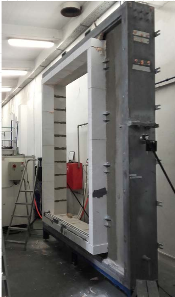
Badania szczelności oraz trwałości rozwiązania w laboratorium ITB w Warszawie.
