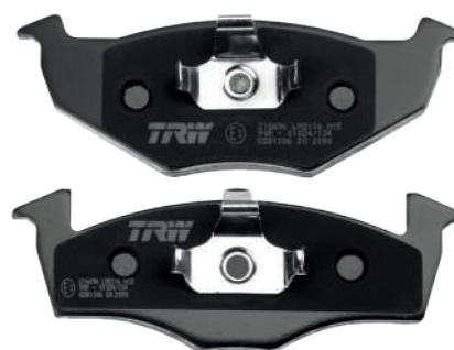
GDB1306 ze sprężyną tłoczka (na górze) i sprężyną do zamocowania klocka po stronie beztłoczyskowej (na dole).
