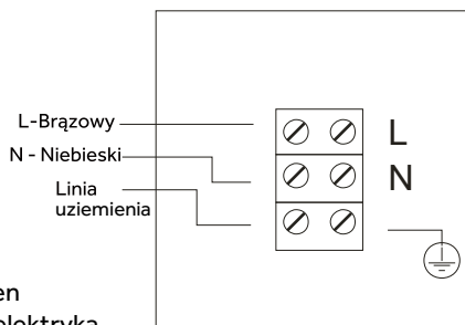
Zaciski przewodów pompy ciepła
