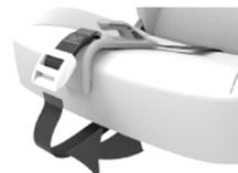
▶ Pas adaptera wkładamy w szczelinę pomiędzy siedzeniem i oparciem, a następnie przekładamy pod siedzeniem do przodu. Przekładając pas pod siedzeniem należy zwrócić uwagę, aby pas nie był skręcony.
