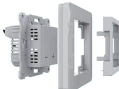
W przypadku korzystania z ramki Schneider Unica zainstalować ramkę i adapter do termostatu w sposób jak pokazano na rysunku obok.
