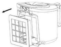
3. Pritisnite lijevak da otvorite lijevak (1) i ispraznite prljavštinu i prašinu.
