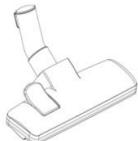
Die Universal-Bodendüse mit ausziehbarer Bürste ist für alle Bodenarten konzipiert. Ziehen Sie beim Saugen glatter, harter Oberflächen die Bürste heraus und schieben Sie sie beim Saugen von Teppichen hinein.
