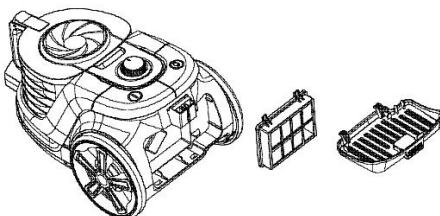
6. Pre hrubé čistenie jemne vyklepte nečistoty z HEPA filtra do odpadkového koša.
