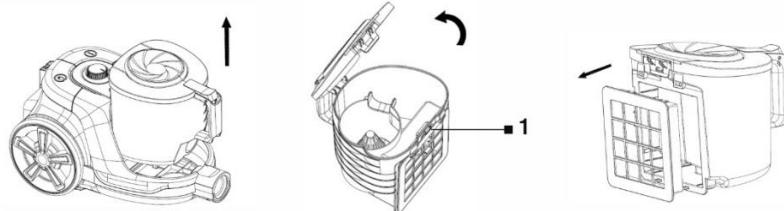
3. Drücken Sie auf die Verriegelung, um das Fach ( 1 ) zu öffnen und den Schmutz und Staub zu entleeren.
