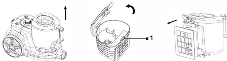
3. Stiskněte pojistku pro otevření zásobníku (1) a vysypejte nečistoty a prach.
