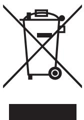
To urządzenie jest oznaczone zgodnie z Dyrektywą Europejską 2012/19/UE oraz polską Ustawą o zużytym sprzęcie elektrycznym i elektronicznym symbolem przekreślonego kontenera na odpady. Takie oznakowanie informuje, że sprzęt ten, po okresie jego użytkowania, nie może być umieszczany łącznie z innymi odpadami pochodzącymi z gospodarstwa domowego.
