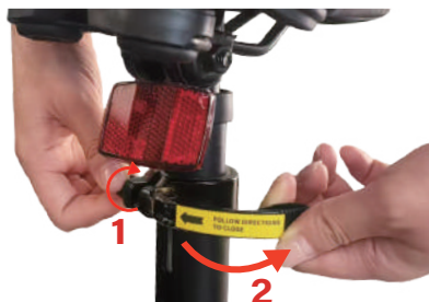
15. Platzieren Sie die Sattelstütze im Sitzrohr. Hinweis: Erhöhen Sie die Höhe der Sattelstütze nicht, um die Mindestmarkierung am Sitzrohr freizulegen. Drehen Sie den Knopf an der Sattelstützenklemme auf die entsprechende Festigkeit und drücken Sie dann auf den Griff, um ihn zu verriegeln.
