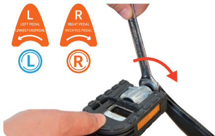
18. Zoek de pedaalas en het pedaal, gemarkeerd met de corresponderende letters, en draai de moeren vast in de richting aangegeven door de pedaalassticker.
