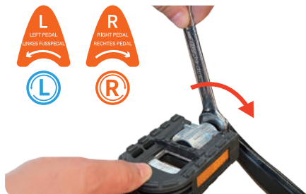
18. Finden Sie die Pedalwelle und das Pedal, die mit den entsprechenden Buchstaben gekennzeichnet sind, und ziehen Sie die Muttern in der auf dem Pedalwellenaufkleber angegebenen Richtung fest.
