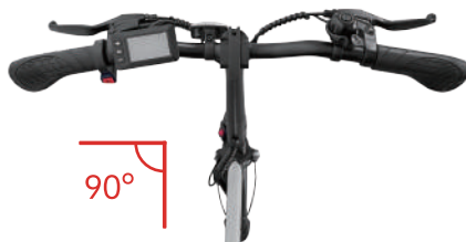
14. Prüfen Sie, ob der Lenker im 90°-Winkel zum Rahmen bzw. Vorderrad steht.
