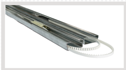
SZYNA CFCCCP 3200/3600/4000 Dwuczęściowa stalowa szyna z paskiem do siłownika ROSSO o długościach 3200/3600/4000 mm do bram o wys. 2500/2800/3200 mm
