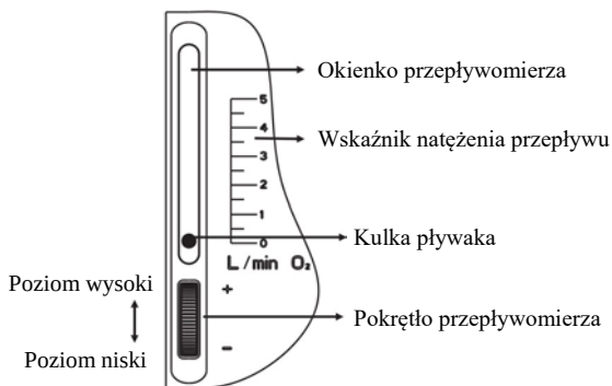
Rys. 6: Ustawianie natężenia przepływu
