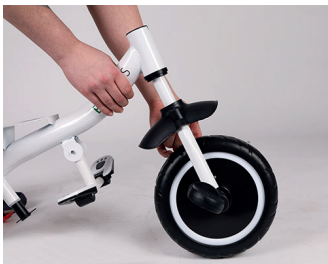
2. Slide the fork into the frame 2. Schieben Sie die Gabel in den Rahmen
