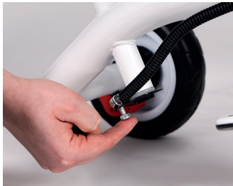
9. Tighten the steering cable 9. Ziehen Sie das Lenkseil fest
