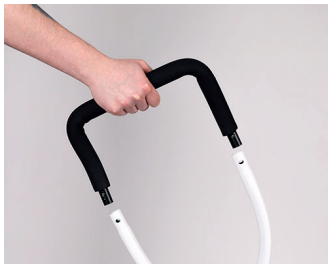
6. Mount the handlebars for guiding the bicycle 6. Montieren Sie den Lenker zur Führung des Fahrrads
