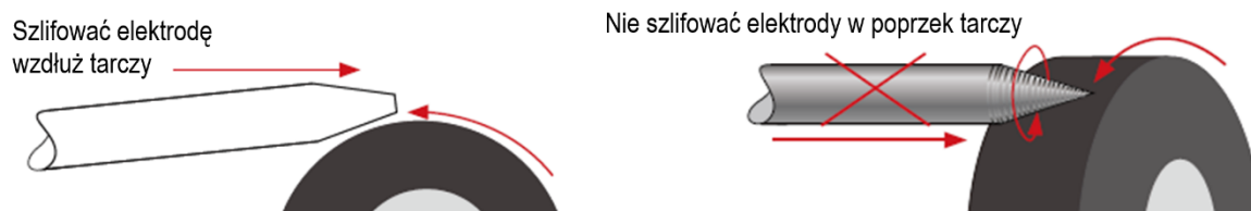
Rys. 22. Szlifowanie elektrody wolframowej
