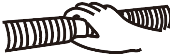
1 - A mangueira de drenagem está embutida no suporte da mangueira.
