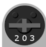
Środkowe położenie potencjometru
