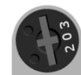
Lewe skrajne położenie potencjometru
