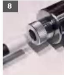
8 Inserire con attenzione la lampada UV nel tubo di quarzo attraverso il dado aperto.
