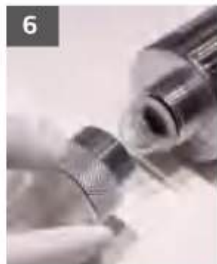
Vissez à la main l'écrou fermé sur la chambre du réacteur (extrémité fermée du tube de quartz) pour protéger le joint torique, ne serrez pas trop.
