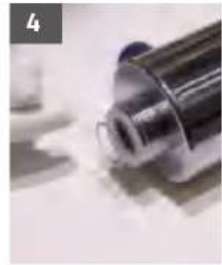
4 Inserire il tubo di quarzo nella camera del reattore.
