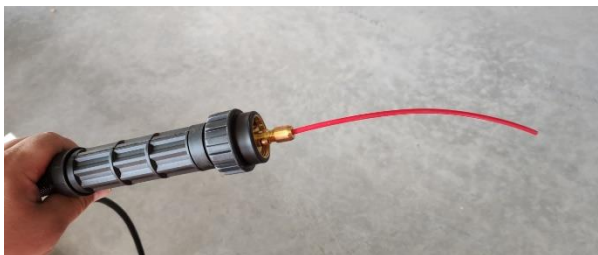
Rys. 11. Teflonowa osłona drutu aluminium w uchwycie spawalniczym MIG
