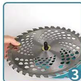
3. Zamontuj tarcze do cięcia, dopasowując ją zgodnie z otworami.
