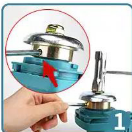
1. Zablokuj wrzeciono kluczem imbusowym, odkręć nakrętkę kluczem nasadowym.
