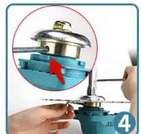
4. Zablokuj wrzeciono kluczem imbusowym i dokręć nakrętkę kluczem nasadowym.
