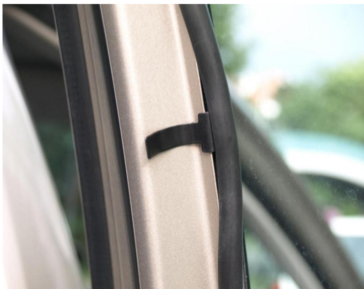
Zdjęcie nr 2 - Sposób montażu zaczepów
