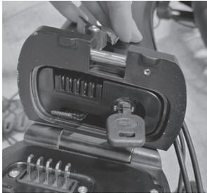
Setzen Sie den mitgelieferten Schlüssel ein und entriegeln Sie den Mechanismus, ziehen Sie die Batterie heraus.
