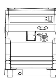
2. Zoek een vlakke plek voor het apparaat waar het beschermd is tegen direct zonlicht en andere warmtebronnen (bijv. fornuis, oven, radiator). Plaats het apparaat op een vlakke ondergrond. Zorg voor ten minste 15 cm ruimte tussen de achterkant en zijkanten van het apparaat en de muur. Plaats niets op het apparaat.
