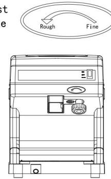
2. Trouvez un emplacement plat pour l'appareil, à l'abri de la lumière directe du soleil et d'autres sources de chaleur (par exemple, cuisinière, four, radiateur). Placez l'appareil sur une surface plane. Laissez au moins 15 cm d'espace entre l'arrière et les côtés de l'appareil et le mur. Ne posez rien sur l'appareil.
