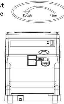
2. Trova un luogo piano per l'elettrodomestico, dove sia protetto dalla luce solare diretta e da altre fonti di calore (ad esempio, fornello, forno, radiatore). Posiziona l'elettrodomestico su una superficie piana. Assicurati che ci siano almeno 15 cm di spazio tra il retro e i lati dell'elettrodomestico e il muro. Non appoggiare nulla sull'elettrodomestico.
