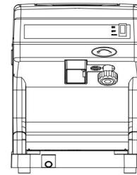
2. Suchen Sie einen ebenen Standort für das Gerät, an dem es vor direkter Sonneneinstrahlung und anderen Wärmequellen (z. B. Herd, Heizung, Heizkörper) geschützt ist. Stellen Sie das Gerät auf eine ebene Fläche. Achten Sie darauf, dass zwischen der Rückseite und den Seiten des Geräts und der Wand mindestens 15 cm Platz sind. Stellen Sie nichts auf das Gerät.
