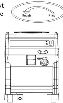
2. Hitta en plan plats för apparaten där den är skyddad från direkt solljus och andra värmekällor (t.ex. spis, ugn, radiator). Placera apparaten på en jämn yta. Se till att det är minst 15 cm utrymme mellan baksidan och sidorna av apparaten och väggen. Placera inget på apparaten.
