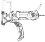
4. Mueva la cuchilla en sentido horario hasta que la punta toque el borde del enchufe.
