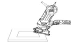
ATTENTION! La lame ne doit pas être en contact avec le matériau avant la mise en marche.
