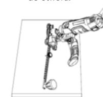
5. Włączyć urządzenie. UWAGA! Prowadnica nie może dotykać materiału aż do momentu uzyskania pełnej prędkości obrotowej przez urządzenie!
