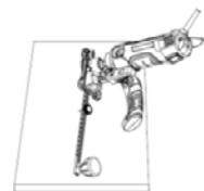
5. Azionare il dispositivo. ATTENZIONE! La rotella di guida non deve toccare il materiale finché l'unità non ha raggiunto la massima velocità!
