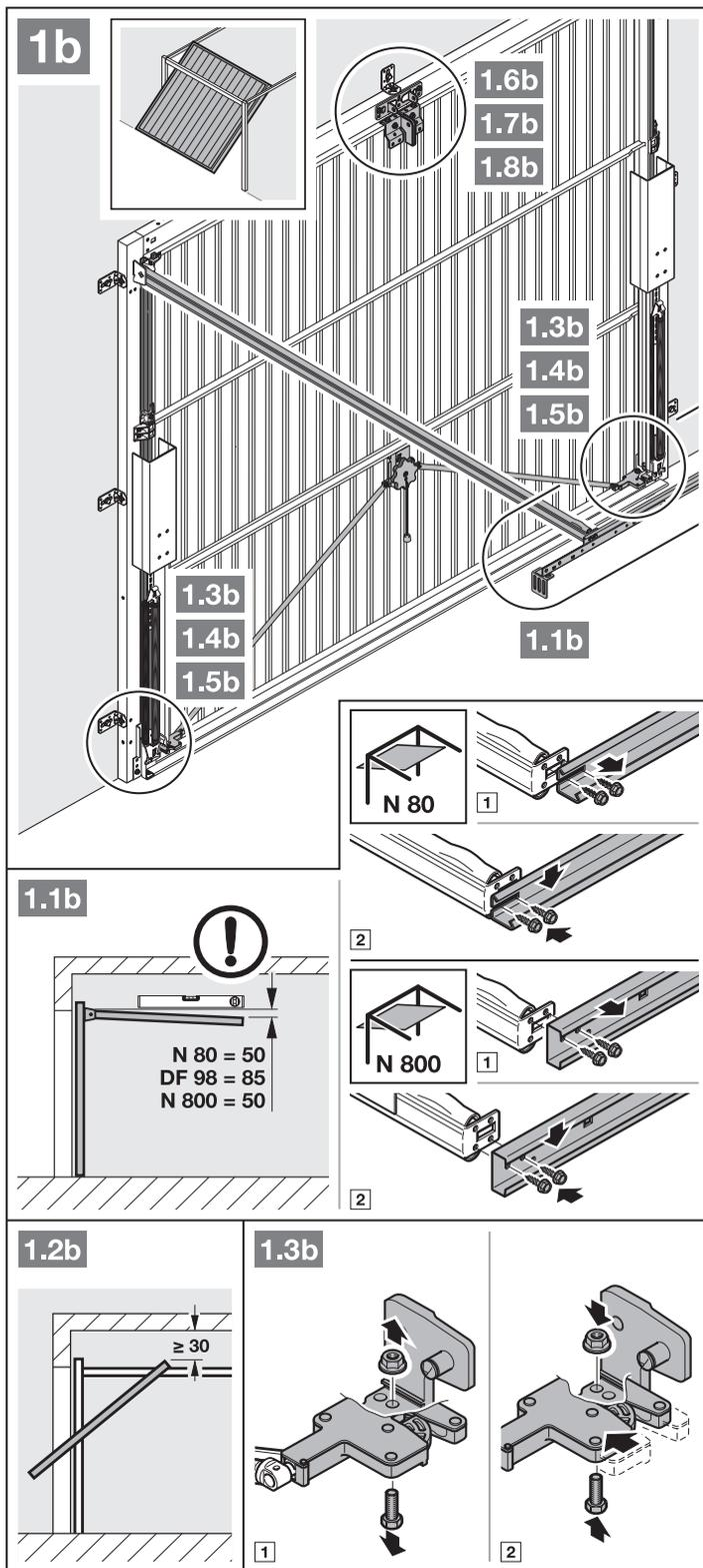
2. Odłączyć mechaniczne ryglowania bramy (patrz rys. 1.4b / 1.5b).
