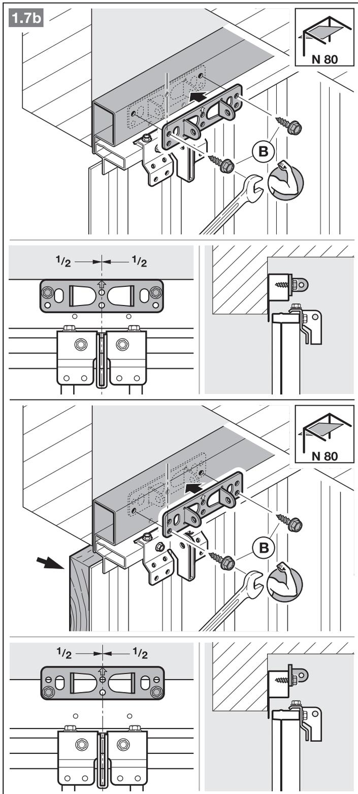
3.4 Монтаж направляющей шины
