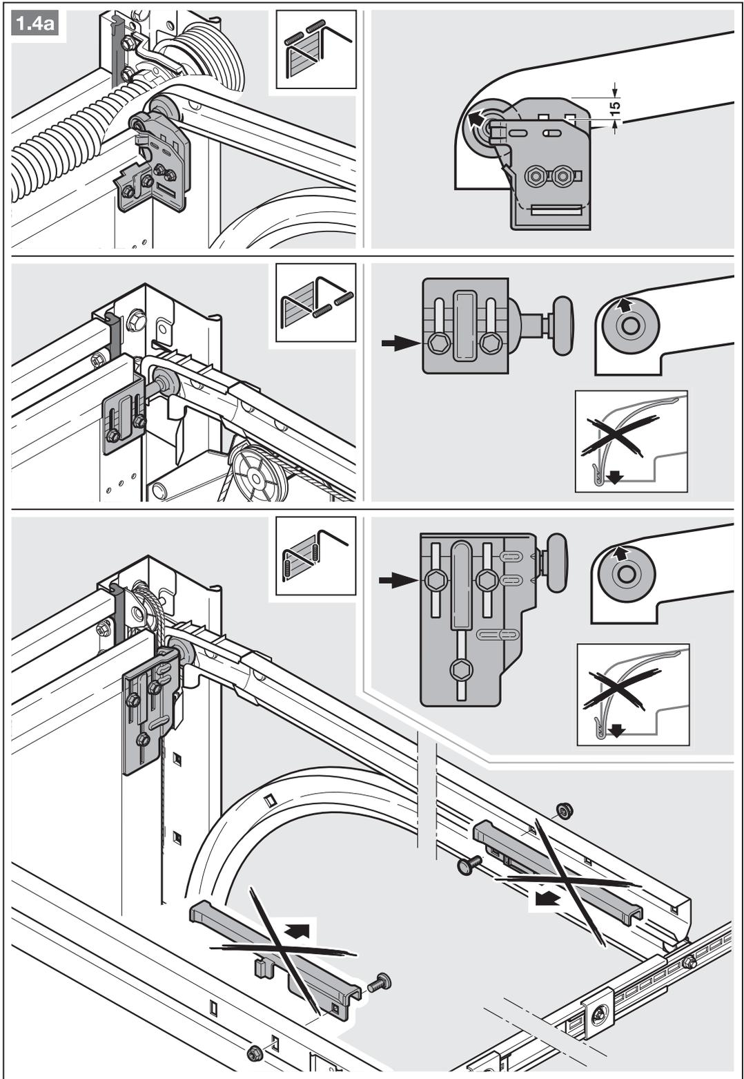
3. U sekčních vrat se středovým zámek umístíte kloub překlady a unášecí úhelník mimo střed (max. 500 mm.)
