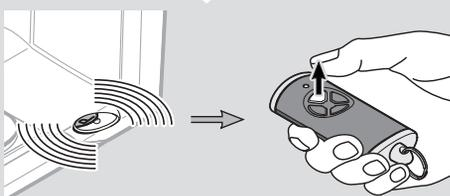
4. Aby zaprogramować kolejne przyciski nadajnika, należy powtórzyć czynności w punkcie 2 + 3.
