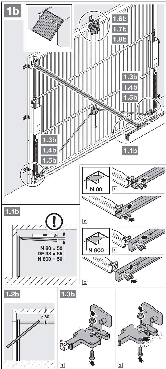
2. Отключите механические устройства блокировки ворот (см. рис. 1.4 b / 1.5 b). Зафиксируйте защелки в случае не представленных здесь моделей ворот.
