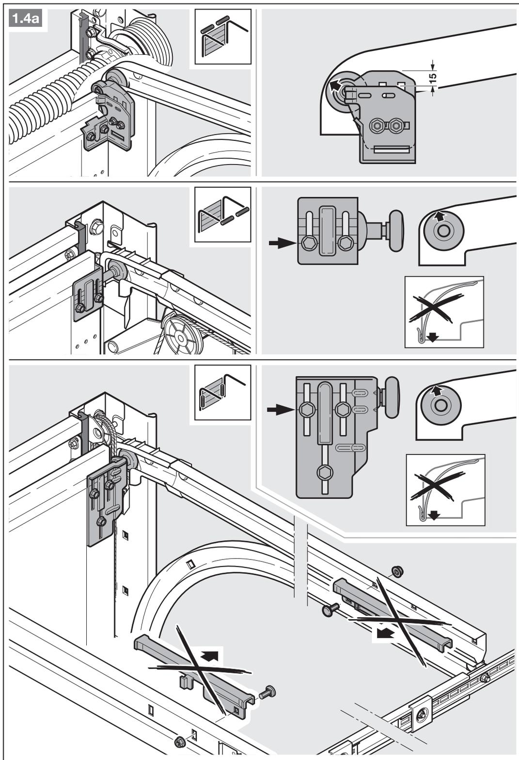
3. Разместите на секционных воротах с затвором, установленным по центру ворот, шарнир перемены и поводковый угольник с отклонением от центральной оси (макс. 500 мм).
