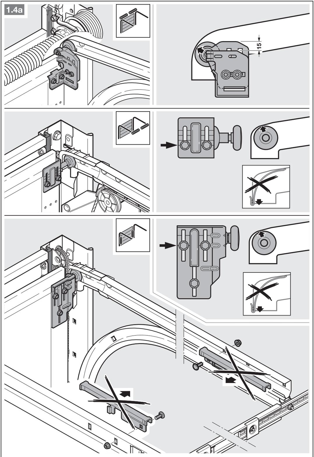
3. Konsolę nadproża i kątownik zabieraka w bramach segmentowych wyposażonych w środkowe zamknięcie należy mocować w odległości maksymalnie 500 mm od osi bramy.
