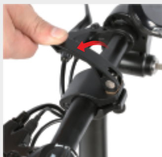
Apriete los tornillos de cierre rápido
