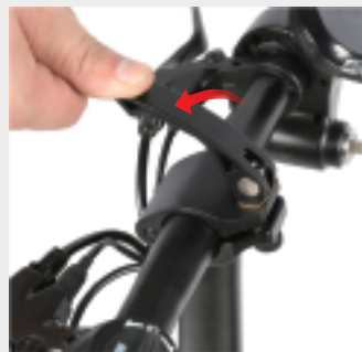
Drücken Sie die Schnellverschlusschrauben fest an
