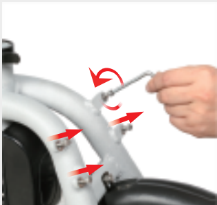
Desserrer les quatre vis dans le bon sens
