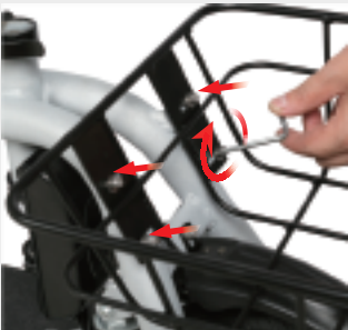
Serrer les quatre vis dans le bon sens
