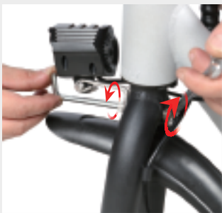
Fixer les vis des deux côtés dans le sens
