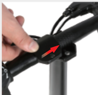
Schieben Sie die Abdeckplatte in die Richtung
