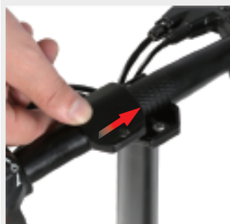
Pousser la plaque de recouvrement dans la direction
