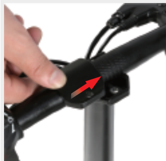
Spingere la piastra di copertura in direzione
