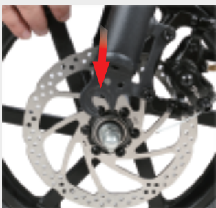
Aligner l'écrou dans le sens
