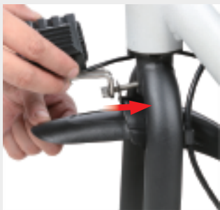
Insérer l'éclairage et l'aile avec les vis
