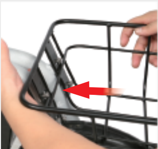
Placer le panier dans l'axe des trous de vis
