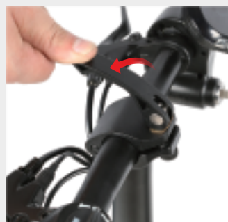
Appuyer fermement sur les vis de fixation rapide
