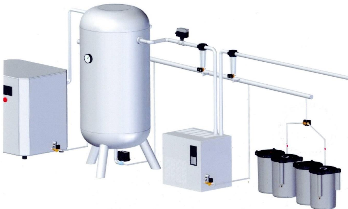
Przykładowa sieć sprężonego powietrza i układ odprowadzania kondensatu
