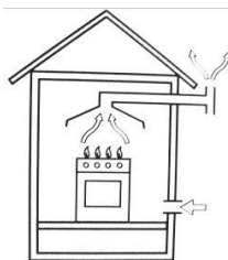
Odprowadzanie na zewnątrz.
