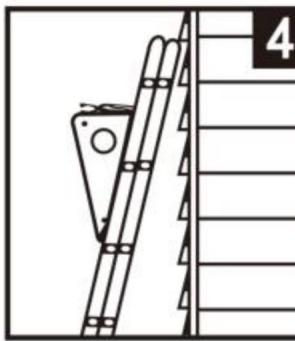
**JACK D'ÉCHELLE** - Positionnez l'outil d'échelle sur le barreau de l'échelle comme indiqué ici avec la planche légèrement penchée dans l'échelle. Dans cette position, l'outil pourra accueillir un bois de 2" x 10" ou 2" x 12".
