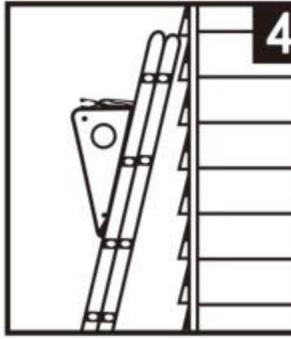
**GATO DE ESCALERA:** Coloque la herramienta de escalera en el peldaño de la escalera como se muestra aquí, con la tabla ligeramente inclinada hacia la escalera. En esta posición, se adaptará a una tabla de madera de 2"x10" o 2"x12".
