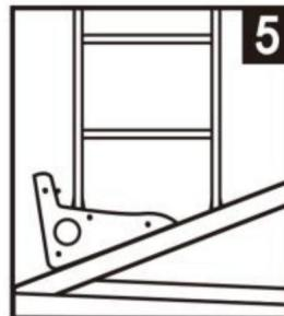
TAKJACK-Denna position är värdefull för att nivellera din stege på tak. Använd endast på ett asfaltspåntak och endast upp till 7/12 stigning.(Visas här på ett tak mindre än 5/12 stigning. (För taklutningar från 5/12 till 7/12, måste vändas och användas på samma sätt som den position som visas i figur 1 ovan). För tak som är brantare än 7/12 stigning, en RoofBoot (tillgänglig från ProVisionTools, Inc.) eller ett träblock spikat på taket för att stödja Ladder Tool är viktigt.
