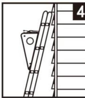
STEGJACK – Placera stegverktyget på stegpinnen som visas här med plankan som lutar något in i stegen. I detta läge kommer den att rymma en 2"x10"eller 2"x12" trä.
