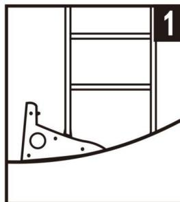
1/12 bis 4/12 NEIGUNG (SANFT) – Diese Position richtet eine Leiter auf einer kleinen bis mittleren Steigung aus. HINWEIS: Platzieren Sie das Leiterwerkzeug immer in einem 90-Grad-Winkel oder senkrecht zu den Seiten der Leiter und üben Sie Druck nach unten aus, wie in diesem Diagramm gezeigt. Die rutschfesten Rampen und die Füße mit Gummikanten bieten Halt.
