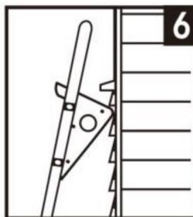
**APAGADO:** esta posición mantiene la escalera alejada de la ventana o de la superficie de trabajo para facilitar el acceso al trabajo.
